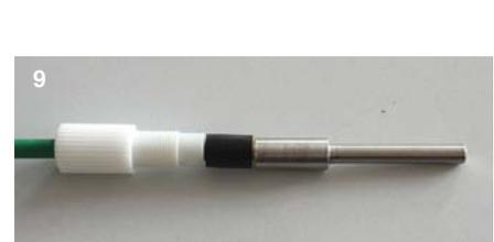
Mettre en place l'électrode centrale
