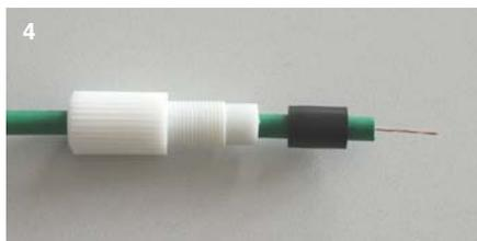
Mettre en place la rondelle-joint néoprène
